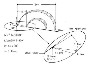
(d) Dimension of the fiber ball radiometer
