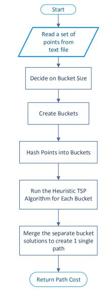
Fig. 2. System Workflow
