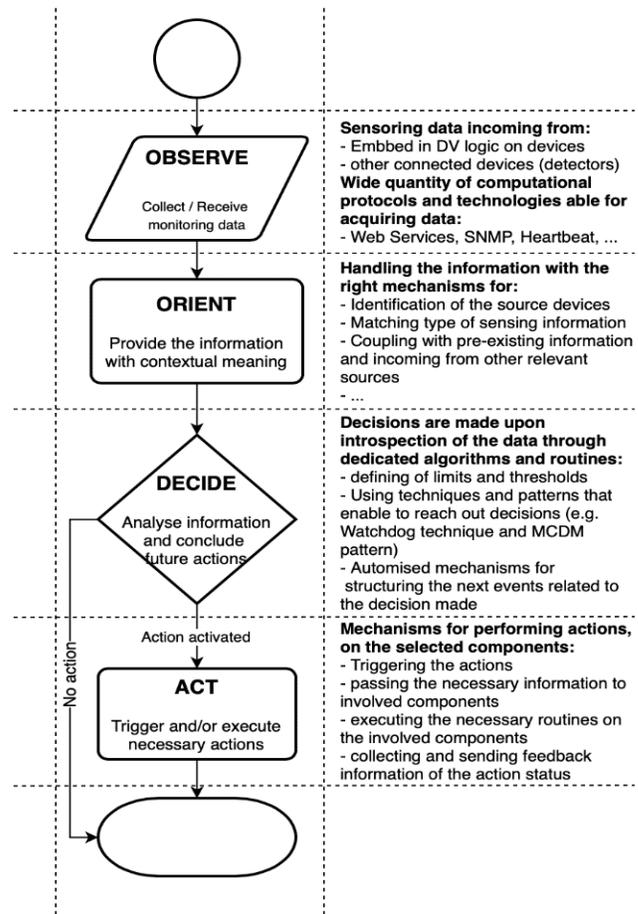
Fig. 7. DV Control Flow Loop.
