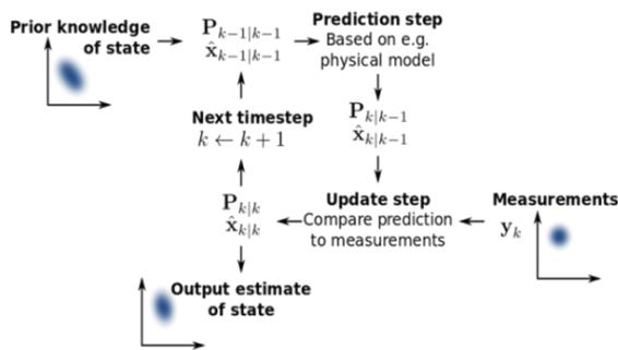
Fig. 1. Kalman Filter Estimator.
