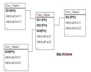
Figure 1. Dimensionnel Model Schema
