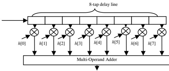
Fig. 1. Basic FIR Filter
