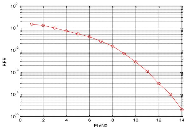
Fig. 18. BER plot versus EbtoNo(dB)
