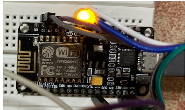
Fig 12. NodeMCU.
