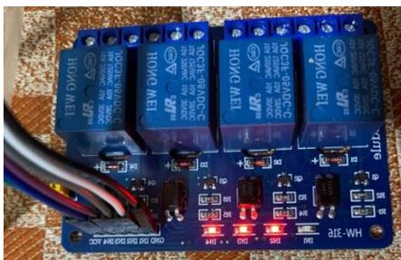
Fig 11. Relay Module (4 Channel).
