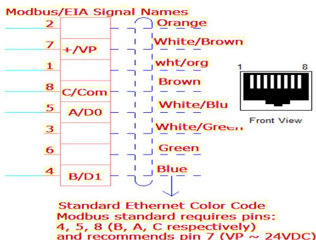
Fig. 5. RJ45 Jack EIA/Modbus Signal Names
