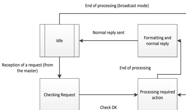
Fig. 10. Modbus Slave State Diagram
